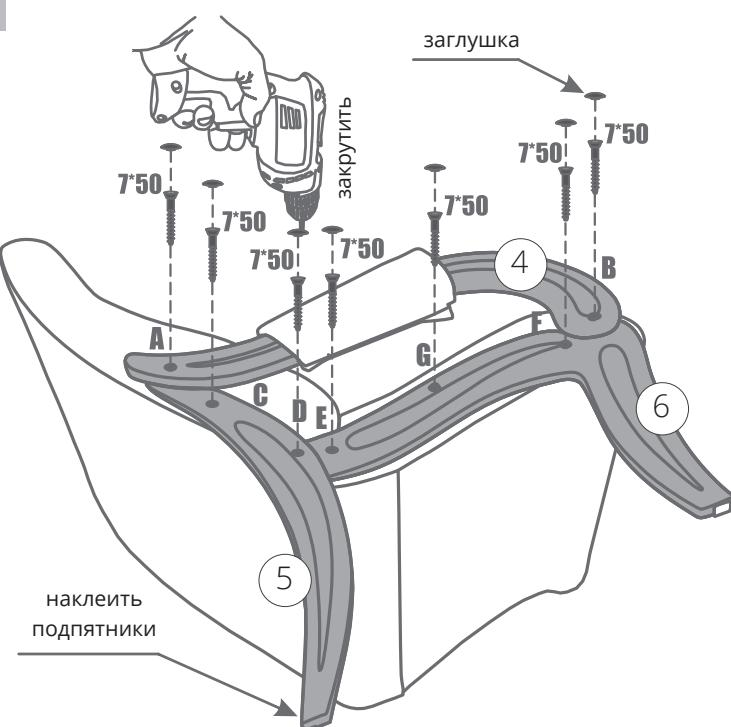
Для предупреждения возможного «вывешивания» опор (ситуация при которой одна или две опоры не касаются пола и изделие стоит не устойчиво), рекомендуем полностью дотянуть стяжки только после того, как установите изделие на пол и сядите в кресло, убедившись, что все опоры касаются пола. Под нагрузкой, опоры самостоятельно выравнивают «вывешивание». После этого можно до конца дотянуть стяжку.
